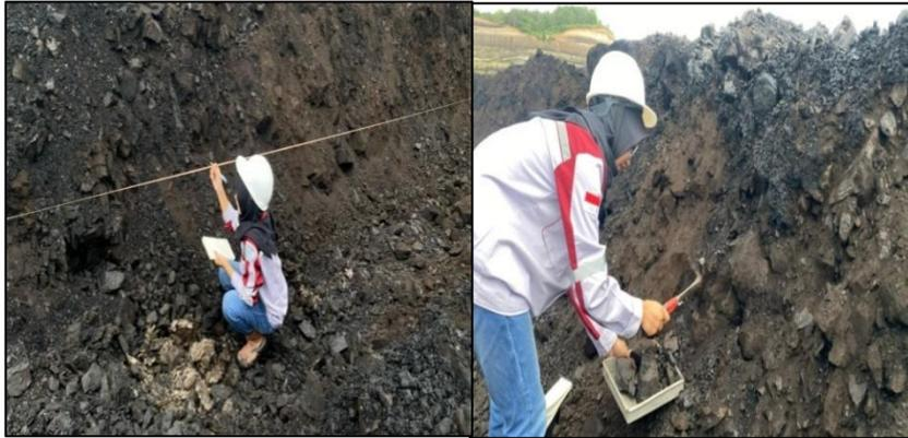
**Gambar 2. Channel Sampling dan Identifikasi Material Pengotor**
