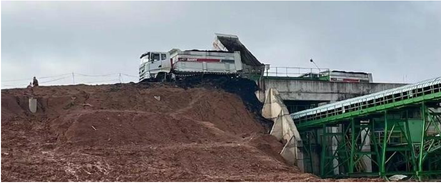
Gambar 2. Proses Unloading Dump Truck ditumpahkan ke Hopper
