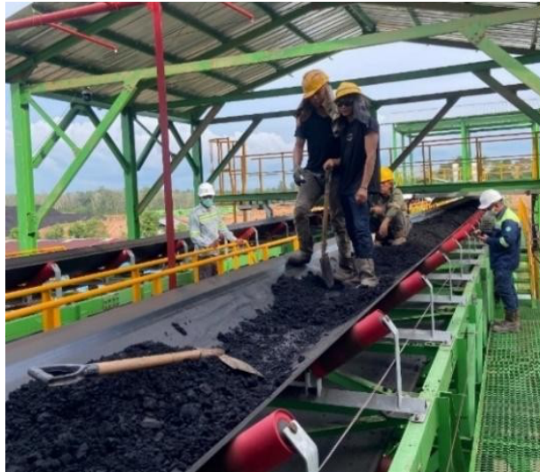
Gambar 4. Pengurangan Materi dari Atas Belt Yang Miring
